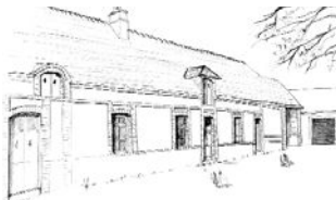
Bâtiment d'habitation d'une ferme, ouvert sur la cour. Maillebois. Les volumes de ces bâtiments sont des parallélépipèdes allongés. Les travées ne sont pas forcément réparties régulièrement. Les baies sont souvent légèrement cintrées. Une lucarne engagée dans le mur, permet l'accès au grenier.
