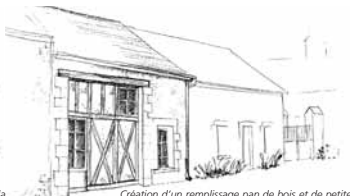
Création d'un remplissage pan de bois et de petites ouvertures, en conservant le dessin de la baie d'origine.
